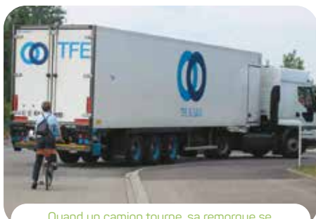
Quand un camion tourne, sa remorque se déplace vers l'extérieur et ses roues coupent le virage à l'intérieur. Ne cherchez donc pas à dépasser un camion, ni par la droite, ni par la gauche.
